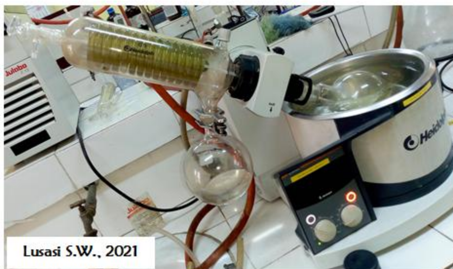
Fig. 4. Dispositif complet d'évaporateur rotatif utilisé lors d'extraction d'huiles de poissons Schilbe grenfelli (©Lusasi S.W., 2021)
