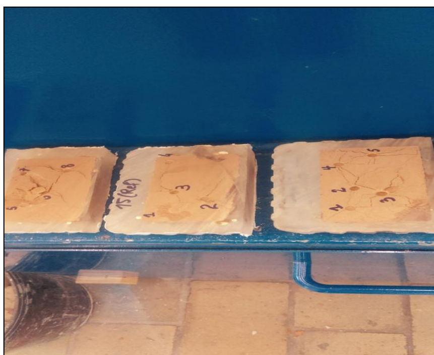
Fig. 6. Cratères formés sur des échantillons à 0%, 5% et 10% de rejets après poinçonnage
