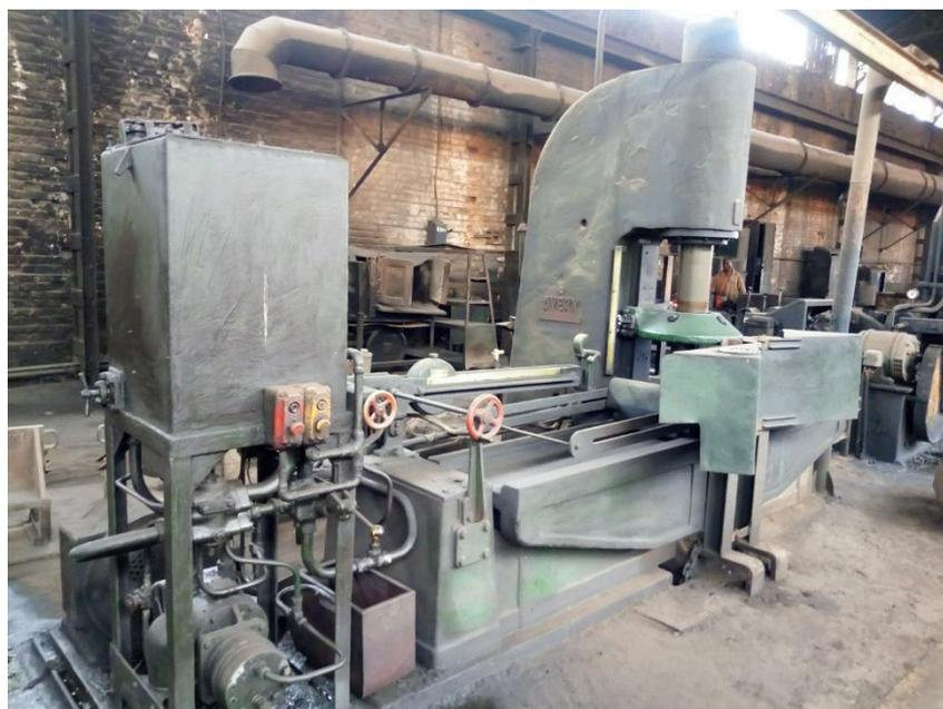
*Fig. 1. Machine à tarer les ressorts*
