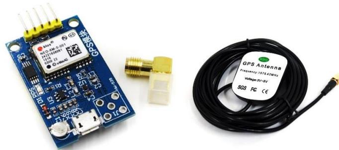
Fig. 4. Module GPS NEO-6M-0-001
