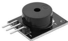
*Fig. 3. Buzzer Piezo électrique*
