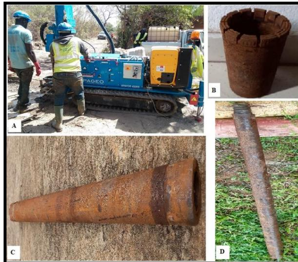
**Fig. 2. Matériel de réalisation d'un sondage carotté**
