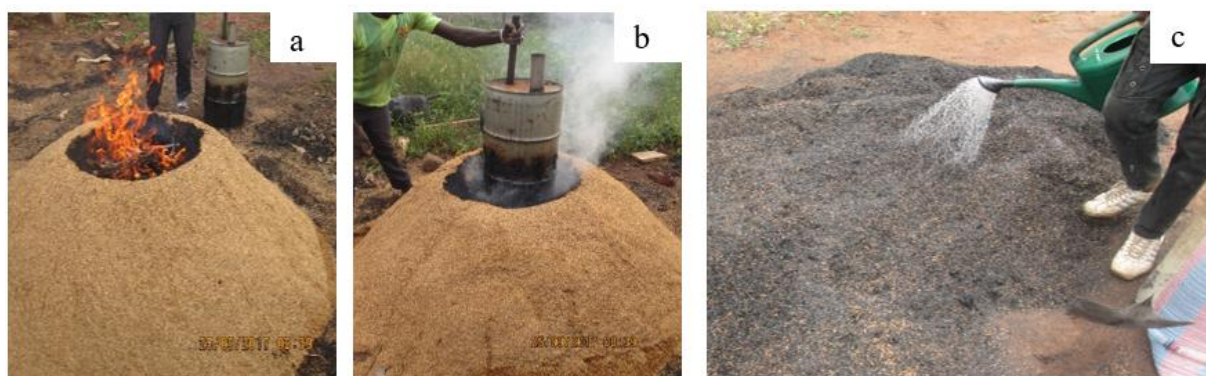
Fig. 3. Etapes de carbonisation des résidus agroindustriels
