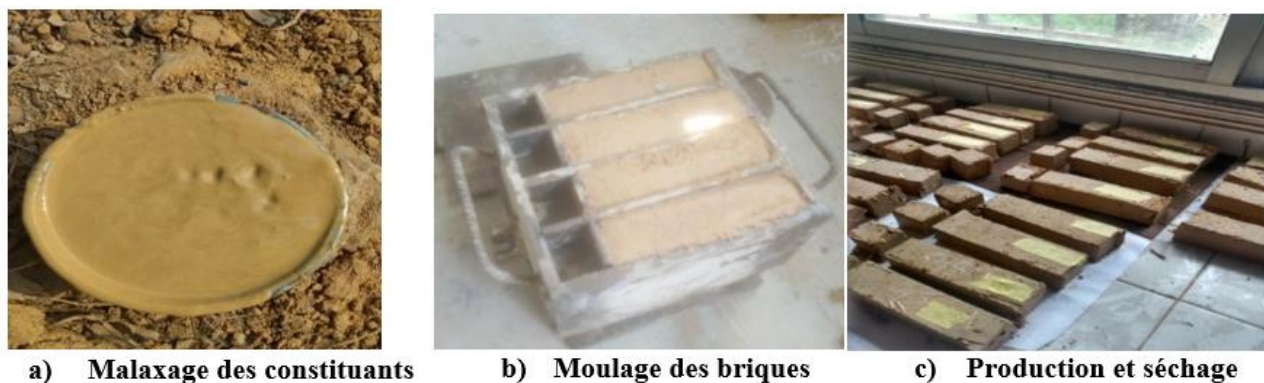
Fig. 8. Malaxage de la terre et du Sissongo, production et le séchage des briques de terre stabilisées
