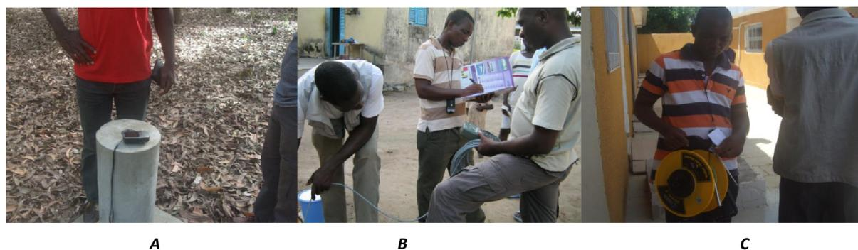
Fig. 2. Matériel utilisé : A : GPS utilisé sur un point géodésique + Point géodésique ayant servi à l'étalonnage du GPS; C : Appareil multi paramètres utilisé pour la détermination des paramètres physiques in situ. B : Sonde piézométrique.
