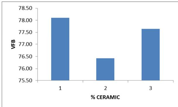
Chart 4. % Ceramic v/s Voids filled with bitumen (VFB).
