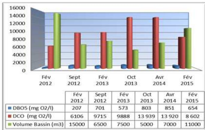
Figure 6 : Evolution de la DBO<sub>5</sub> et la DCO
