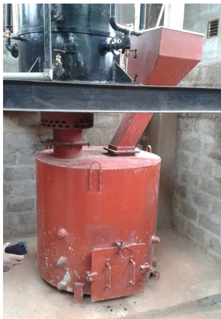
Fig. 1. Four de pyrolyse produisant les biocharbons de coques d'anacarde au Bénin
