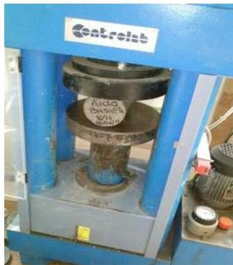
Fig. 24. splitting tensile test
