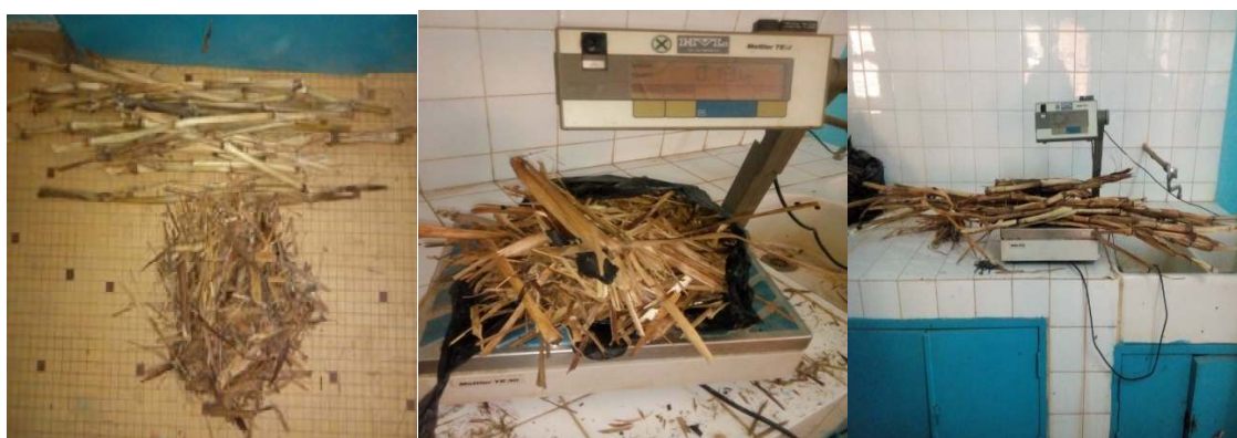
Fig. 5. Tiges de mil effeuillées (a), pesée des feuilles de deux (2) poquets (b), et pesée des tiges uniquement (c)
