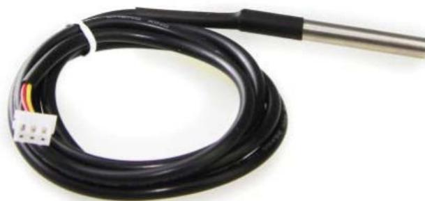
*Fig. 3. DS18B20 temperature sensor*
