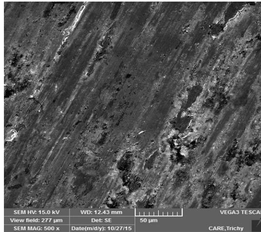
**Fig. 6 (d) SEM image on worn-out surfaces of Fe-1%C-1%Ti**
