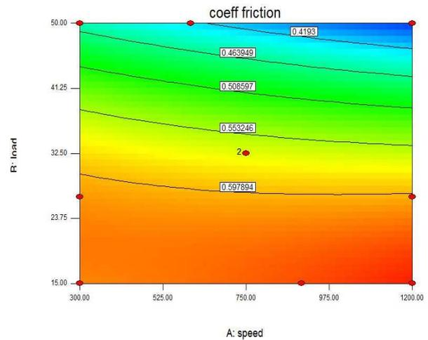
Fig.3 (d) 2D -contour surface plot graph for Fe-1%C-1%Ti
