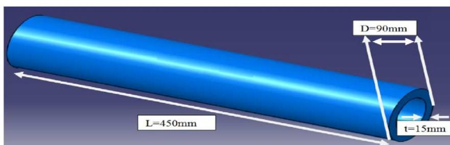
**Fig. 1. Pipes dimensions**
