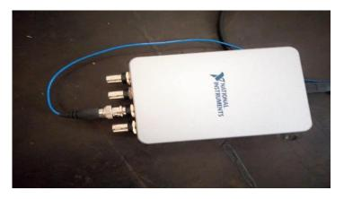
Fig. 5. Système d'acquisition cDAQ avec module 9215
