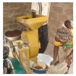
Fig. 3. Crusher COBEMAG
