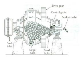
Figure1.2.3 (d) A conical ball mill
