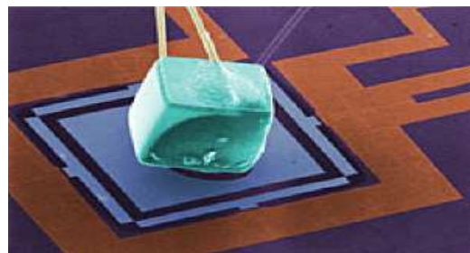
Fig. 11. (a) Principe de fonctionnement du cryo-générateur à base d'extraction d'électrons chauds. (b) Refroidissement d'un cube métallique (image par microscope à électron)
