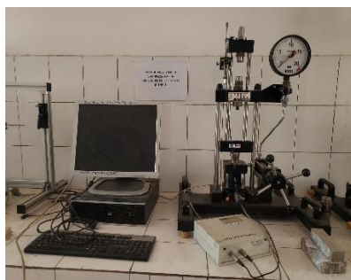
Fig. 1. Machine d'essai universelle WP 300 pour essai de traction
